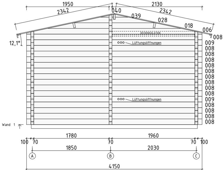
Die Bohlen mit Lüftungsöffnungen können je nach Bedarf höher oder niedriger eingesetzt werden. Bitte achten Sie darauf dass die Lüftungsöffnungen von innen nicht mit der Saunabank bedeckt werden!
