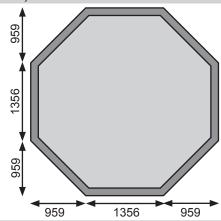
Fundamentplan (in mm) bei Aufbau mit Fußboden:
