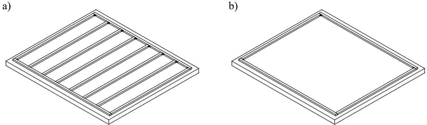
2. Betonblöcke. Im Falle einer Bestellung des Gartenhauses mit Fußboden, ist ein Fundament zu errichten (siehe Bild) (verschiedene Variante möglich). Befestigen Sie den Unterkonstruktionskranz (Perimeter) an Blöcken mit 8 Stck. Mauerschrauben 7,5x92mm (im Set enthalten) entfernt ca. 40 cm von der Eckverbindungsschnittstelle. Die Fußbodenbalken sind mit Metallwinkeln zu befestigen (im Set enthalten).
