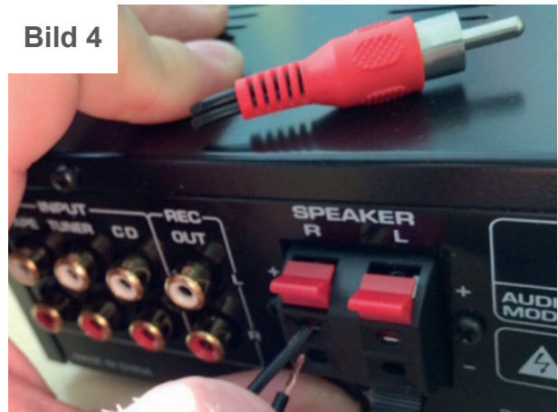
Zuletzt die gesplitteten Verbindungen mit dem Audiogerät „Speaker R“ und „Speaker L“ verbinden.
