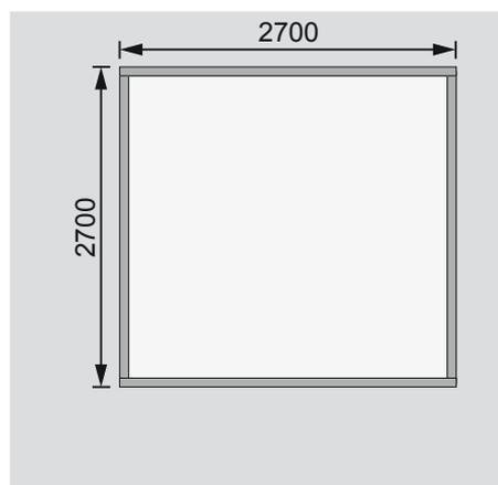
**Fundamentplan mit Boden (in mm)**
