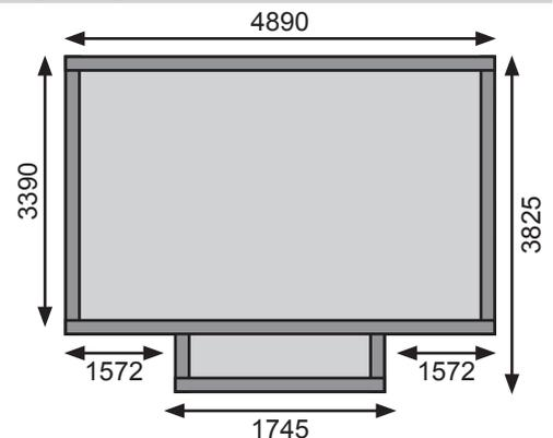
Fundamentplan (in mm) bei Aufbau mit Fußboden:
