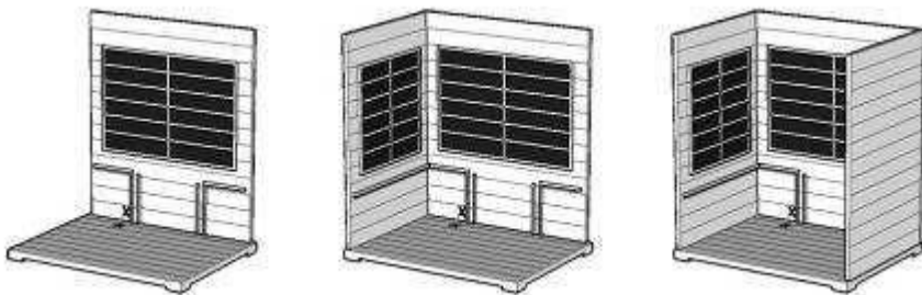
Abbildung C-2: Hintere und seitliche Platte
