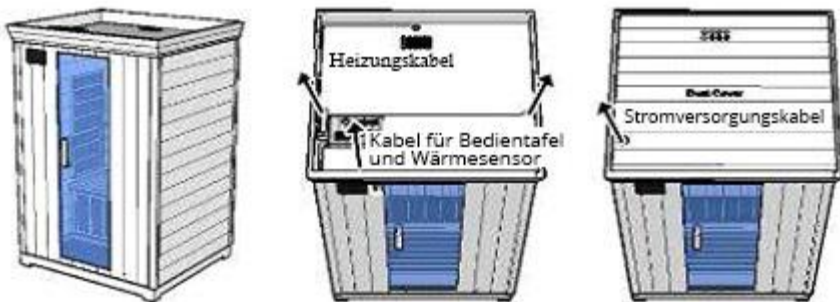
Abbildung A-6: Obere Platten und Anschlüsse
