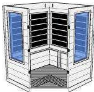
Abbildung B-4: Montieren der Frontplatten
