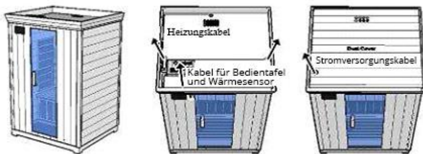
Abbildung A-6: Obere Platten und Anschlüsse
