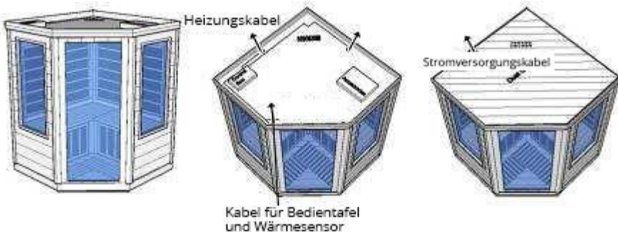
Abbildung B-8: Obere Platten und Anschlüsse
