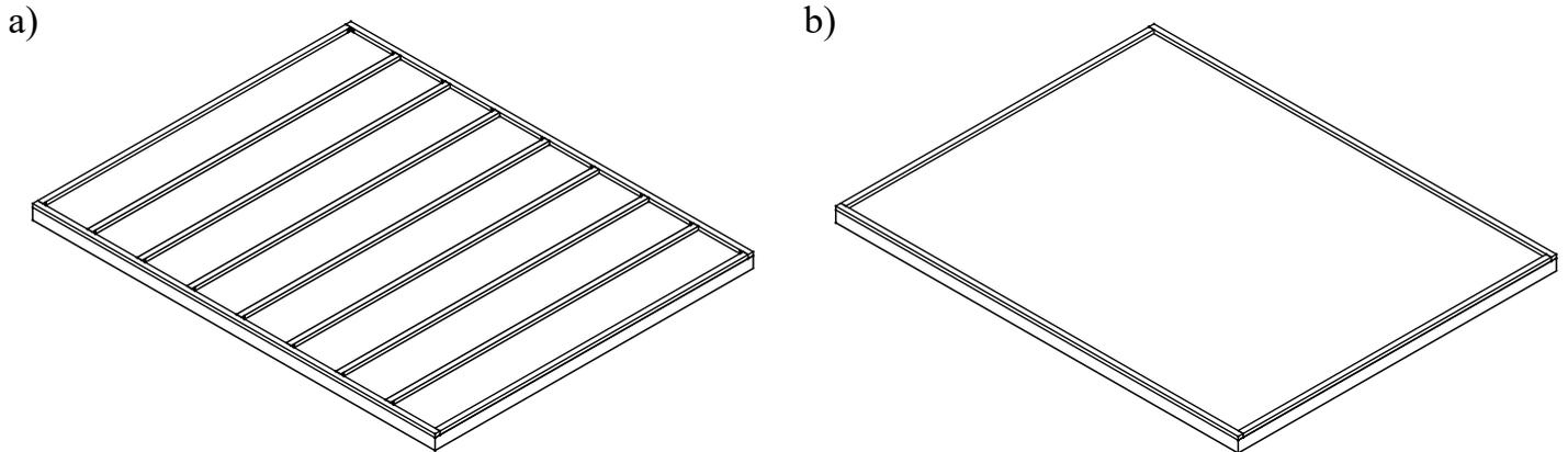
2. Betonblöcke. Im Falle einer Bestellung des Gartenhauses mit Fußboden, ist ein Fundament zu errichten (Siehe Bild) (verschiedene Variante möglich). Befestigen Sie den Unterkonstruktionskranz (Perimeter) an Blöcken mit 8 Stck. Muerschrauben 7,5x92mm (im Set enthalten) entfernt ca. 40 cm von der Eckverbindungschnittstelle. Die Fußbodenbalken sind mit Metallwinkeln zu befestigen (im Set enthalten).
