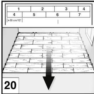
Die zweite Reihe mit einem halben Paneele oder dem Rest der 1. Reihe beginnen [16, 17]. Hierbei ist zu beachten, dass das Paneele nicht kleiner als 30 cm bzw. nicht länger als 95 cm ist. Der Fugenversatz (Querfugenversatz) muss von Reihe zu Reihe jeweils bei min. 30 cm liegen.
