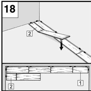
Ein zweites Paneele stirnseitig (kurze Seite) mit einem Winkel von 30° in die Nutprofilierung des voran liegenden ersten Paneels einfügen [14] und dann auf den Boden flach ablegen. Darauf achten, dass die Längskanten in einer Flucht liegen und keinen Versatz bilden und eine gerade Linie bilden. Dies ist notwendig, um bei der Verlegung der 2. Reihe die Paneele fugenfrei in die Längsprofilierung einsetzen zu können.
