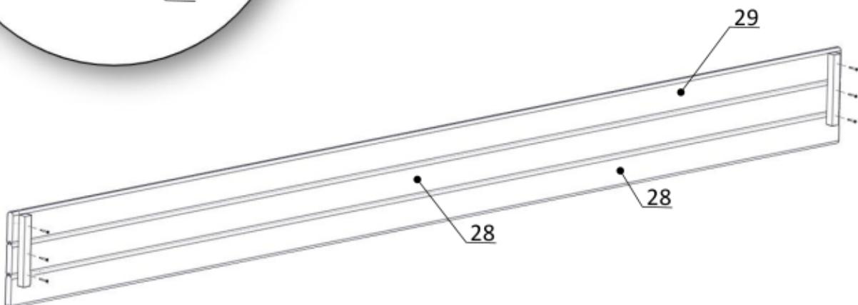
**Dwa boki:** przesunięcie listwy montażowej 30mm.
