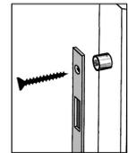
b) das Schließblech soll direkt auf den Pfosten geschraubt werden: Dazu Löcher in den Pfosten bohren, damit später Riegel und Falle des Schlosses dort hineinpassen.
