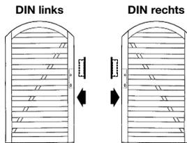
Das Schloss ist für rechts und links anschlagende Tore verwendbar. Dazu die Falle ggf. um 180° drehen:
