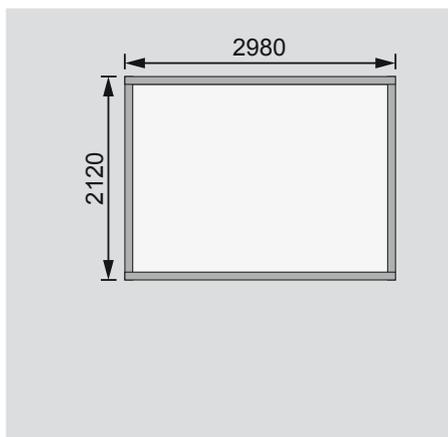
**Fundamentplan mit Boden (in mm)**
