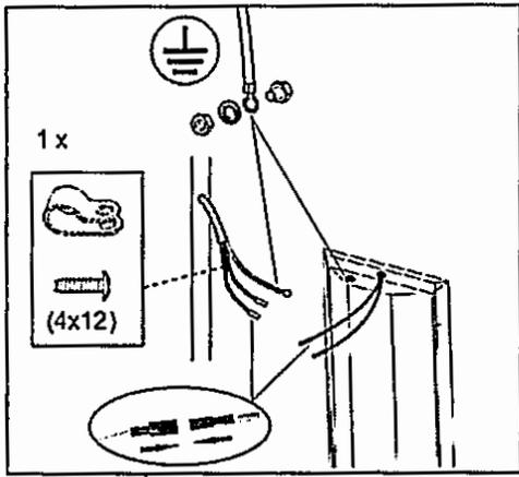
1) Schrauben Sie die Heizung an der Heizungsblende fest.
