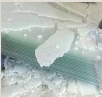
Die SYSTEM GLAS Elemente bestehen aus 8 mm starkem **Einscheiben-Sicherheitsglas (ESG)**. Bei der Produktion wird das Glas in einem Spezialofen auf circa 600° C erhitzt und dann schockgekühlt. Der Produktionsprozess sorgt für beste Sicherheit und Festigkeit. Bei Bruch zersplittern die SYSTEM GLAS Scheiben in kleine stumpfe Teile. Diese Art der Herstellung bedeutet aber auch, dass sich die Scheiben nicht kürzen lassen!
