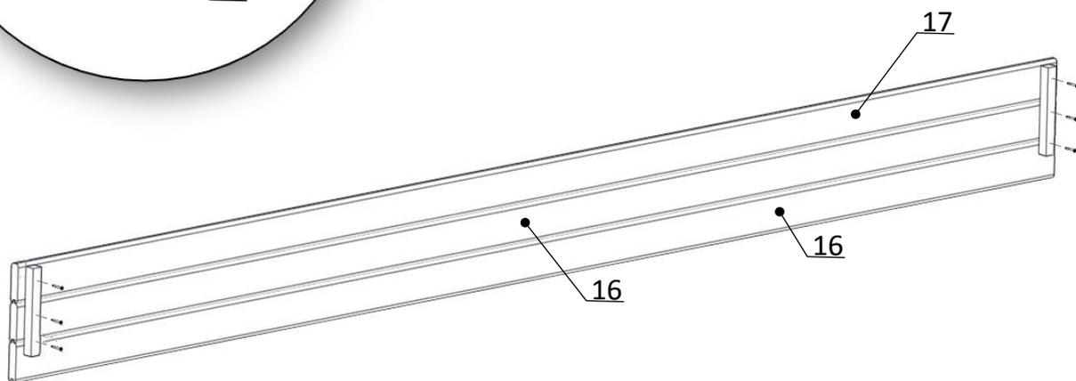
**Bok: przesunięcie listwy montażowej 30mm.**
