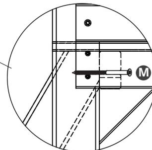
Die Leiter wird mittig zwischen den Pfosten positioniert und von hinten verschraubt. Es wird empfohlen Balken vorzubohren.
