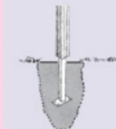
! Erst nach Austrocknen des Fundaments mit den Arbeiten fortfahren
